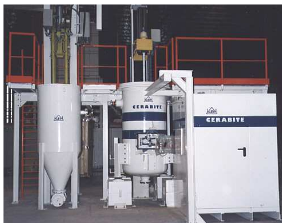
Fig. 5: Hauptkomponenten einer Stoßwellenbehandlungsanlage
